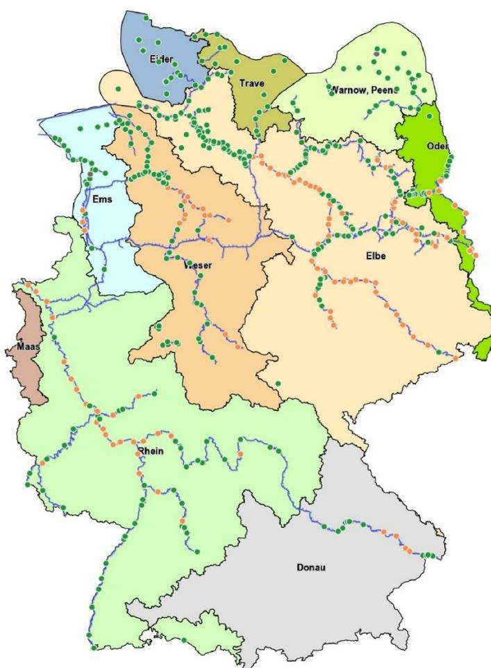
**Abb. 3:** Pegelkarte für Deutschland vom 27.07.2022. Orange Markierungen zeigen Pegel, die aktuell Niedrigwasserstände kleiner oder gleich dem mittleren jährlichen Niedrigwasserstand (MNW) aufweisen (nur Bundeswasserstraßen, Quelle: GeoPortal.WSV).
