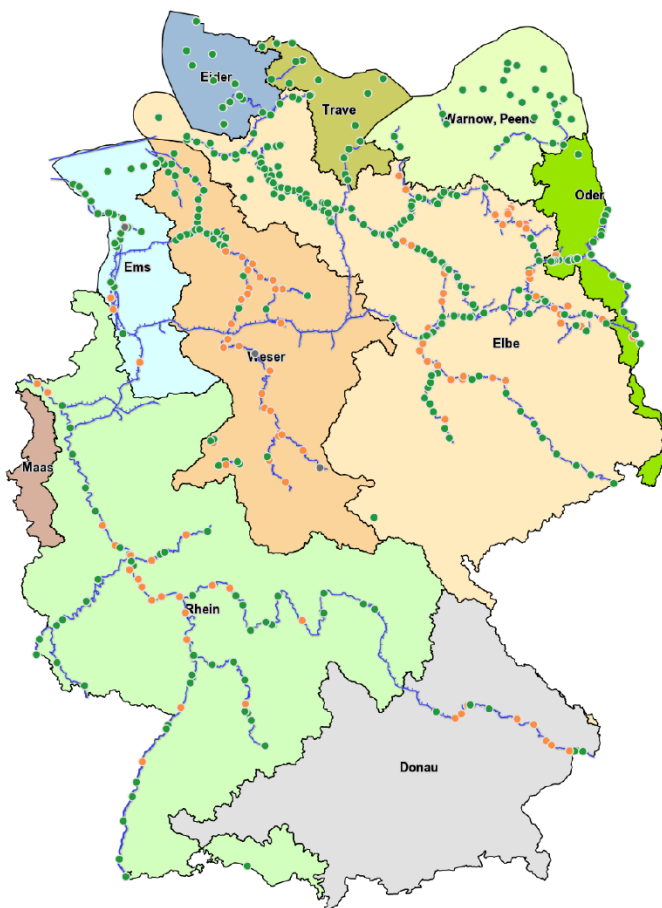
Abb. 3: Pegelkarte für Deutschland vom 08.09.2022. Orange Markierungen zeigen Pegel, die aktuell Niedrigwasserstände kleiner oder gleich dem mittleren jährlichen Niedrigwasserstand (MNW) aufweisen (Quelle: GeoPortal.WSV).
