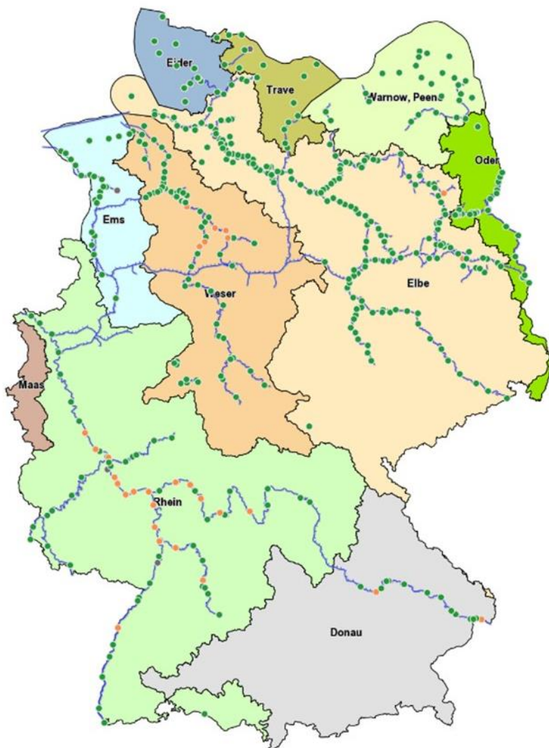
Abb. 3: Pegelkarte für Deutschland vom 25.11.2021. Orange Markierungen zeigen Pegel, die aktuell Niedrigwasserstände kleiner oder gleich dem mittleren jährlichen Niedrigwasserstand (MNW) aufweisen (Quelle: GeoPortal.WSV).
