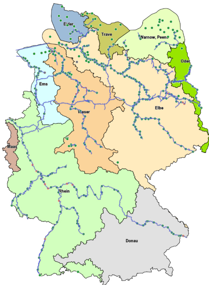
Abb. 3: Pegelkarte für Deutschland vom 18.11.2021. Orange Markierungen zeigen Pegel, die aktuell Niedrigwasserstände kleiner oder gleich dem mittleren jährlichen Niedrigwasserstand (MNW) aufweisen (Quelle: GeoPortal.WSV).
