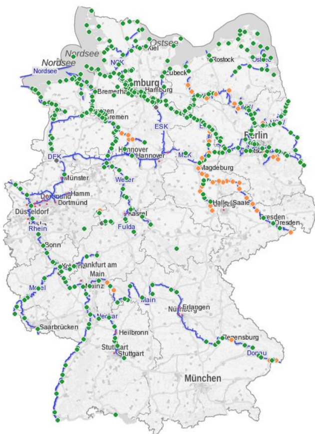
Abb. 3: Pegelkarte für Deutschland am 20. Dezember 2018. Orange Markierungen zeigen Pegel mit Niedrigwasserstand (Quelle: PegelOnline/WSV)
