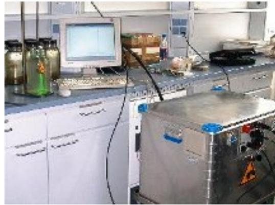
Kalibrierung des Laser-Fluoreszenzsenors zur Messung des Tracers Sulforhodamin G
